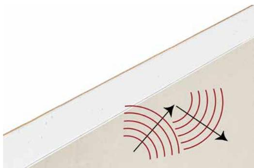
En raison de leur propriété de matériau dur, les dalles de plâtre peuvent de plus réfléchir quelques-unes des ondes sonores dans la pièce. Ces ondes sont réfléchies par les parties non perforées, notamment lde par les bords de la zone perforée. La réflexion est plus importante avec les plaques non perforées, et leurs performances d'absorption acoustique se limitent à leur effet de membrane.
